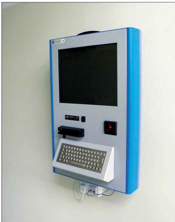
Wykonanie kiosku ściennego dla firmy Radmot
